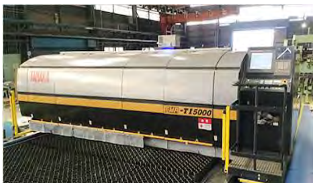
8KW発信器搭載型ファイバーレーザー切断機
