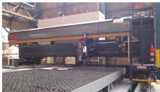
6KW発信器搭載型CO2レーザー切断機
