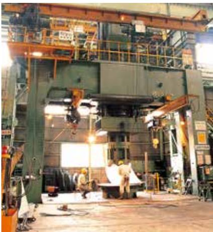
きわめて径の大きい鏡板および特殊形状の鏡板は、分割工法で成形します。各部材をプレス工法により、成形加工した後、組み立てて溶接します。
