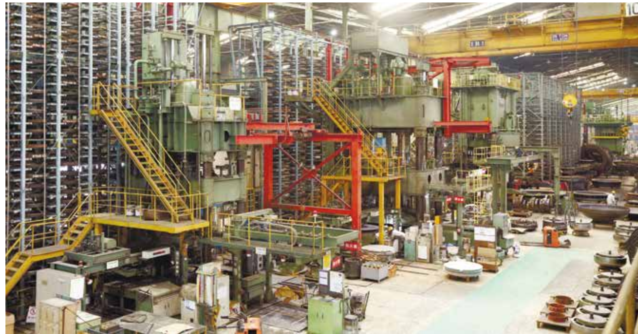
各種の全自動鏡板専用プレスと、金型自動立体倉庫の連動で、短時間で大量の鏡板が生産されます。
