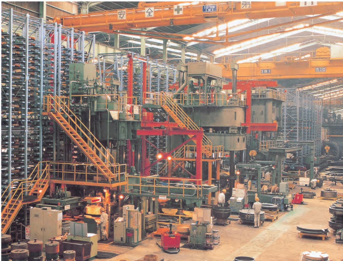
各種の全自動鏡板専用プレスと、金型自動立体倉庫の連動で、短時間で大量の鏡板が生産されます。
