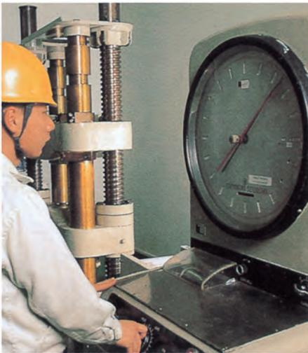
1000kN 万能引張試験機
