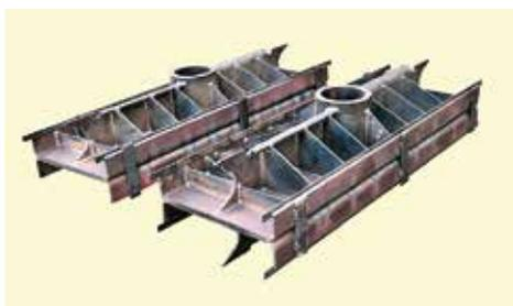
台車横ハリ内部補強溶接
