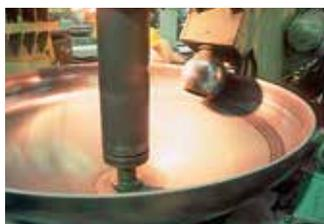
□スピニング加工(冷間) Spinning (Cold)
